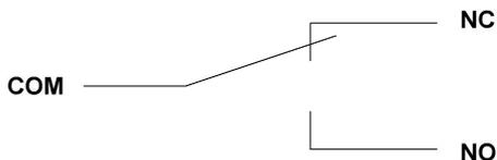
Die Abbildung verdeutlicht den Aufbau des Schaltkontaktes.
