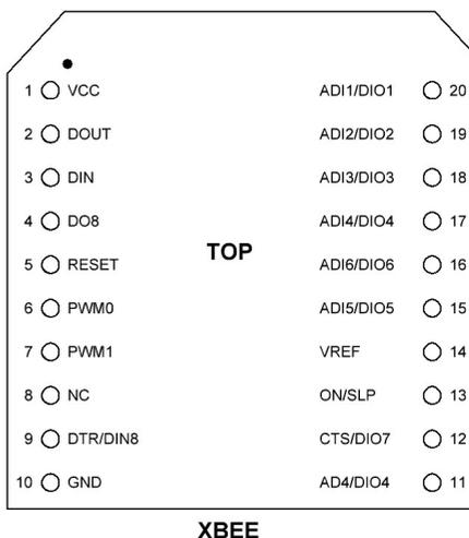
Folgende Übersicht zeigt die benötigten Kontakte, für die serielle Kommunikation zwischen Arduino™ und dem Funkmodul:
