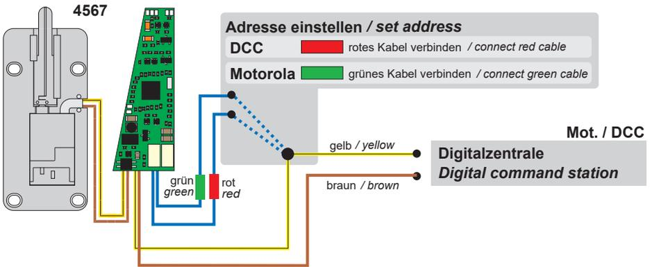
Sie können über diese als Lötflächen ausgeführten Kontakte die Stellung der Weichenzunge an ein geeignetes Steuerungssystem zurückmelden oder Schaltvorgänge, wie eine separate Herzstückpolarisierung, auslösen.
