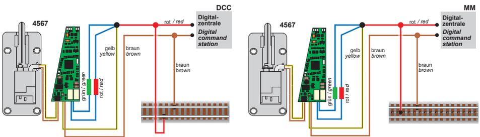
Anschluss nach Adressprogrammierung für invertierte Stellrichtung!
