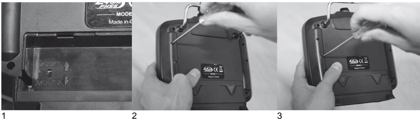
4. Lösen Sie die Schraube rechts unten vollständig bis den Schraubenkopf mit der Rückseite eben ist.
