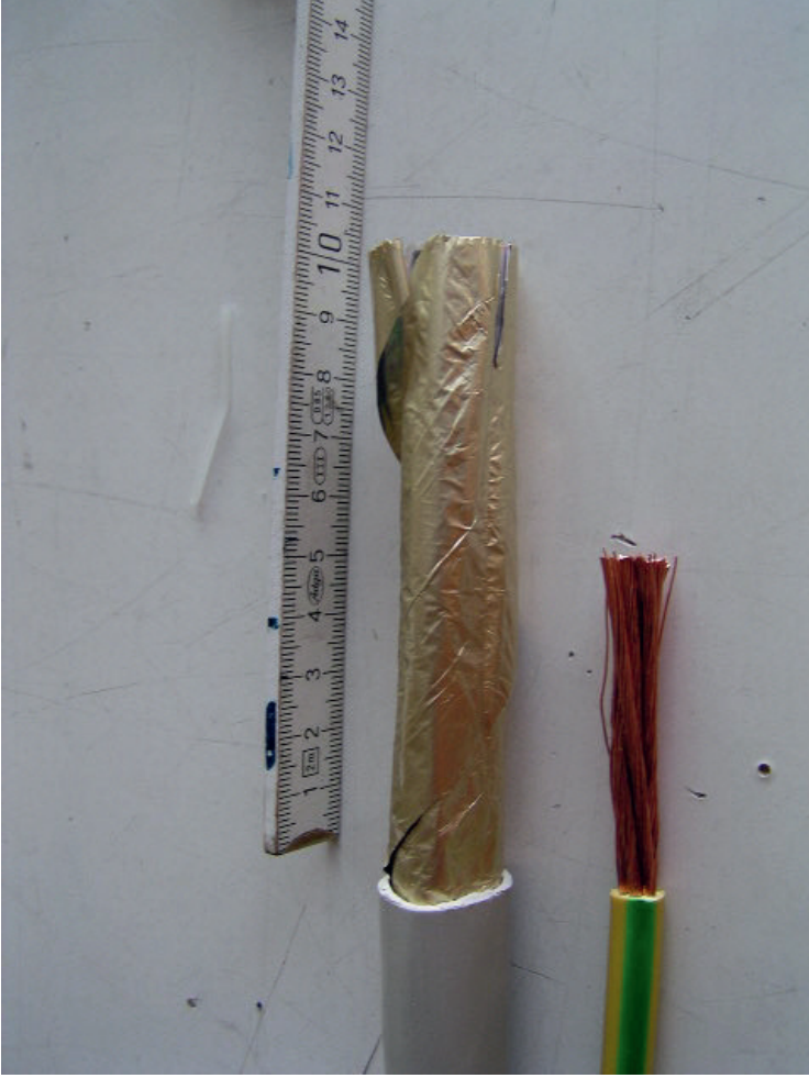
Bild. 4.1: z.B. Kabel JE-Y(ST)Y 40x2x0.8 (für Kontakt-Rollfeder SA KRF 22 V2A ca. 10 cm abisolieren und PE 1x16 mm 2 (mehrdrähtig) ca. 5cm abisolieren.
