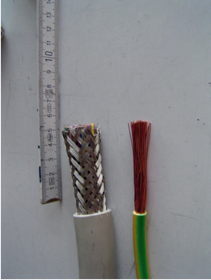
Bild. 3.1: z.B. Kabel JE-LIYCY 32x2x0.5 für Kontakt-Rollfeder SA KRF 22 V2A und PE 1x16 mm 2 (mehrdrähtig) ca. 5 cm abisolieren.
