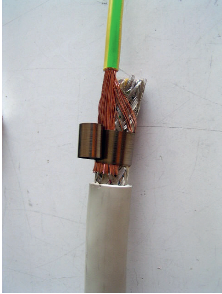
Bild. 3.3: Kontakt-Rollfeder SA KRF 22 V2A um beide Kabel herumwickeln.
