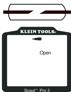
CABLE COAXIAL CON UNA ABERTURA:
