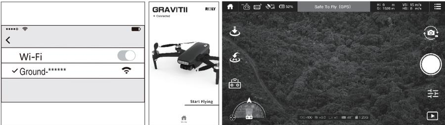
Öffnen Sie die Gravitti App und prüfen Sie, ob als Drohnenstatus oben links „Connected“ (Verbunden) angezeigt wird. Wenn dort „Connected“ steht, klicken Sie auf „start flying“ (Flug starten), um die Bedienoberfläche aufzurufen.
