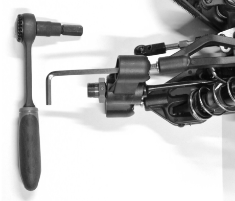
Kogelkopschroef (A en B) instellen
