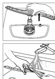
Kamień i zanieczyszczenia z wody zmywającej mogą blokować dysze i łożyska ramienia spryskiwacza. Regularnie sprawdzaj dysze wylotowe ramienia spryskiwacza pod względem zatorów.
