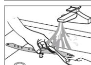
Dýzy a ložiská striekacieho ramena môžu blokovať kotolný kameň a nečistoty z oplachovacej vody. Výstupné dýzy striekacieho ramena pravidelne kontrolujte, či nie sú upchané.
