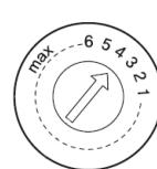
Saque la tapa del dispensador de asistente de enjuague y ajuste el dial al nivel deseado. La configuración de fábrica es "4".
