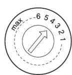
Sejměte víko dávkovače prostředku na oplachování a ovladač nastavte na požadovanou úroveň. Tovární nastavení je „4“.
