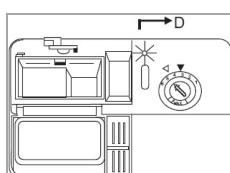
Si el testigo de advertencia del asistente de enjuague no se enciende en el panel de control, puede valorar la cantidad de asistente de enjuague restante respecto al indicador de nivel óptico (D) al lado del dispensador.
