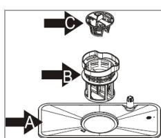
Das dreiteilige Filtersystem verhindert, dass größere Mengen an Speiseresten oder Fremdkörpern in das Spülssystem gelangen.
