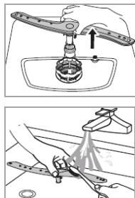
Kalk und Verunreinigungen aus dem Spülwasser können Düsen und Lagerungen des Sprüharms blockieren. Kontrollieren Sie die Austrittsdüsen des Sprüharms regelmäßig auf Verstopfungen.
