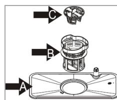
Trojdielny filtračný systém zabraňuje vniknutiu väčších kusov jedla a iných predmetov do čerpadla.
