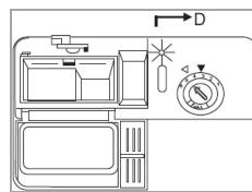
Pokud se varovná kontrolka prostředku oplachování na ovládacím panelu nerozsvítí, tak můžete odhadnout zbývající množství prostředku na oplachování na optickém ukazateli úrovně (D) vedle dávkovače.
