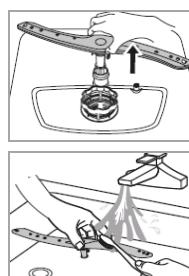
La cal y las impurezas del agua de lavado pueden obstruir boquillas y rodamientos del brazo de rociado. Compruebe con regularidad si existen obstrucciones en las boquillas de salida del brazo de rociado.
