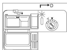
Als het glansmiddel-controlelampje op het bedieningspaneel niet brandt, kunt u de hoeveelheid resterend glansmiddel schatten met behulp van de optische niveau-indicator (**D**) naast het reservoir.
