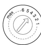
Nehmen Sie den Deckel des Klarspülmittelbehälters ab und drehen Sie den Wahlschalter in die gewünschte Stellung. Die Werkseinstellung ist "4".
