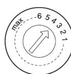
Haal het deksel van het glansmiddel-reservoir af en draai de knop naar het gewenste niveau. De fabrieksinstelling is "4".
