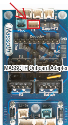
Abbildung 1: Anschluss der Pantographenantriebe an Decoder und Schnittstellen Illustration #1: Connecting the Pantograph drive to Massoth Decoder and interfaces
