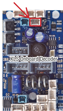
Abbildung 1: Anschluss der Pantographenantriebe an Decoder und Schnittstellen Illustration #1: Connecting the Pantograph drive to Massoth Decoder and interfaces
