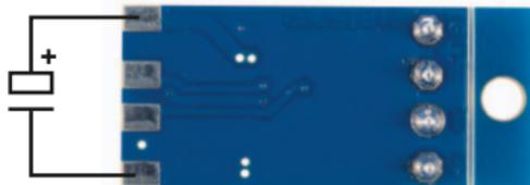
**Abbildung 4: Anschluss eines Pufferkondensators (max. 1000  $\mu$ F/35V)**
