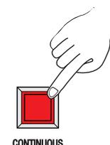
Der Dauerbetrieb hat Priorität vor dem Timer-Betrieb, d. h. bei gedrückter roter Taste ist die Maschine immer auf Dauerbetrieb eingestellt, selbst wenn der Timer-Betrieb mit der gelben Taste eingestellt ist.
