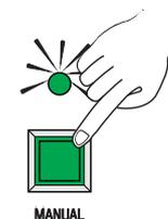
Der manuelle Betrieb hat Priorität vor dem Dauerbetrieb und dem Timer-Betrieb, d. h. beim Drücken der grünen Taste stößt das Gerät immer Nebel aus, selbst wenn eine der beiden anderen Betriebsarten eingestellt ist.
