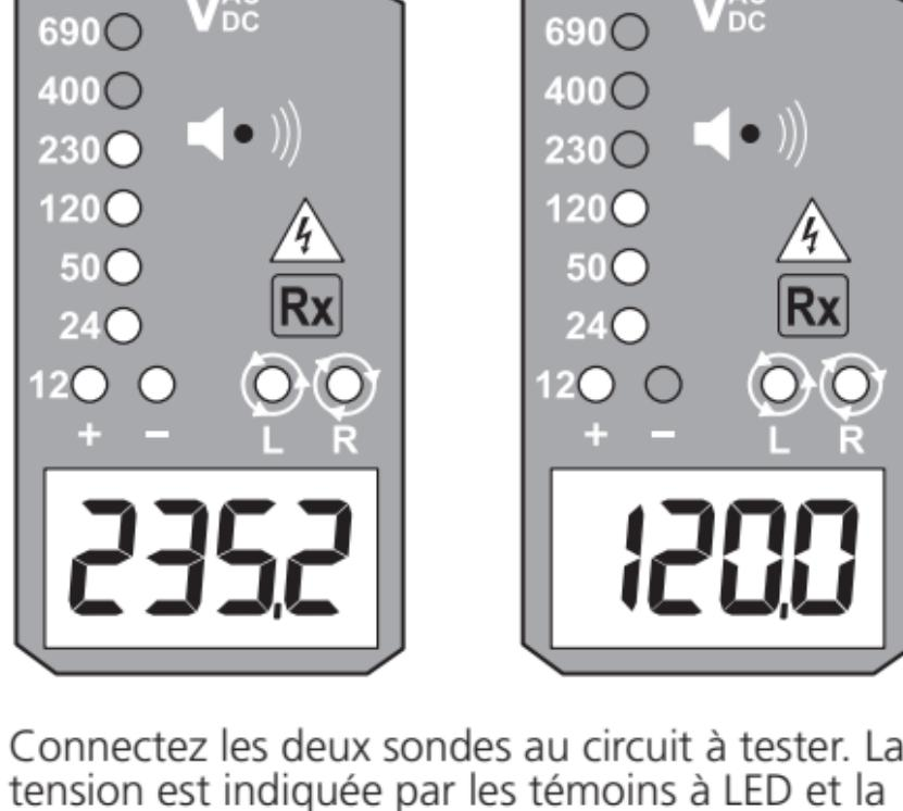
Connectez les deux sondes au circuit à tester. La tension est indiquée par les témoins à LED et la valeur s'affiche sur l'écran (Display) LCD.
