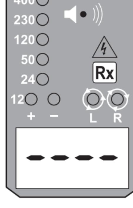
Assicurarsi che il circuito da testare non sia alimentato. Collegare entrambe le sonde per il test al circuito. Il LED di continuità(Continuity LED) si illumina e il cicalino emette un suono continuo per indicare una continuità  $< 500 \text{ k}\Omega$ . Nota: Non è disponibile nessuna misurazione della continuità sul display LCD.
