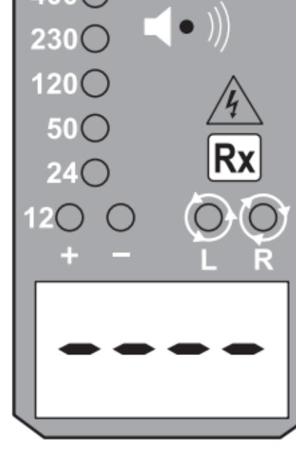
Sprawdzić, czy badany obwód nie znajduje się pod napięciem. Podłączyć obie sondy testowe do obwodu. Kontrolka diodowa ciągłości obwodu (continuity LED) zaświeci się i brzęczyk wyda
