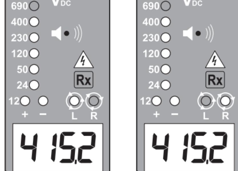
Kontrolki diodowe L i R testu wirowania fazy mogą działać na różnych układach okablowania, ale skuteczny wynik testu można uzyskać tylko w trójfazowych układach 4-przewodowych.
