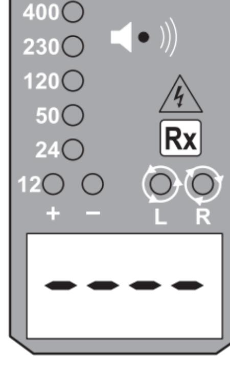
Vergewissern Sie sich, dass der zu prüfende Stromkreis spannungsfrei ist. Verbinden Sie die beiden Prüfspitzen mit dem Stromkreis. Die LED Durchgang leuchtet und der Summer ertönt dauernd, um Durchgang anzuzeigen  $<500\text{ k}\Omega$ . Hinweis: Auf der LC-Anzeige wird die Durchgangsprüfung nicht angezeigt.
