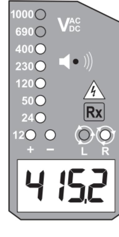
Faz rotasyon testi için L LED'i ve R LED'i çeşitli kablolama sistemlerinde çalışabilir, fakat etkili bir test sonucu sadece üç-fazlı 4-telli sistemlerde elde edilebilir.
