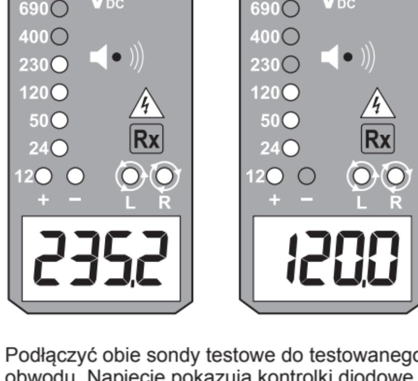
Podłączyć obie sondy testowe do testowanego obwodu. Napięcie pokazują kontrolki diodowe i wyświetlacz LCD.
