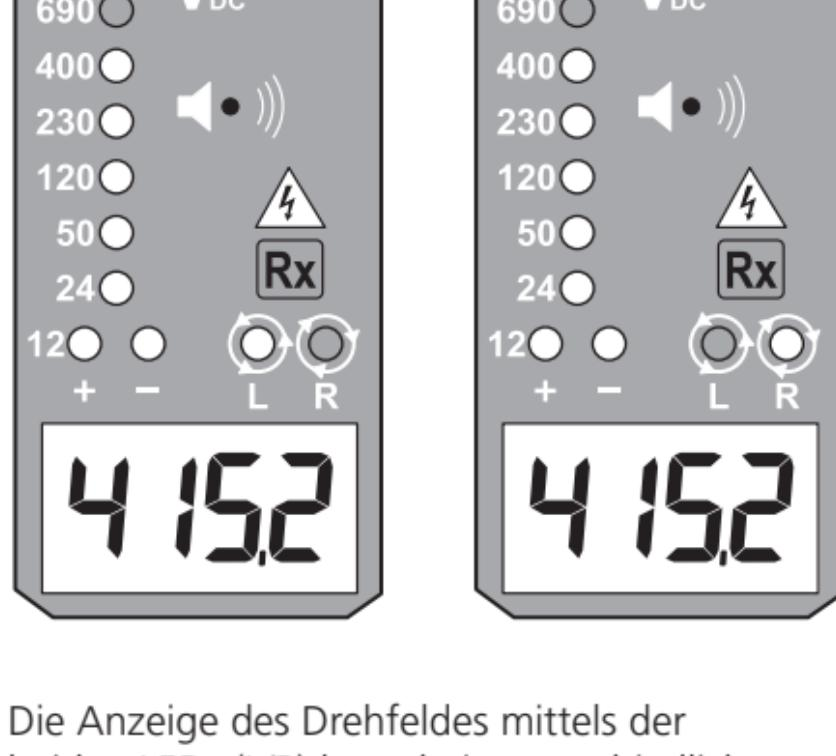
Die Anzeige des Drehfeldes mittels der beiden LEDs (L/R) kann bei unterschiedlichen Netzsystemen funktionieren, aber eine korrekte Anzeige des Drehfeldes ist nur in einem geerdeten 4-Leiter-System mit 3 Außenleitern gewährleistet.
