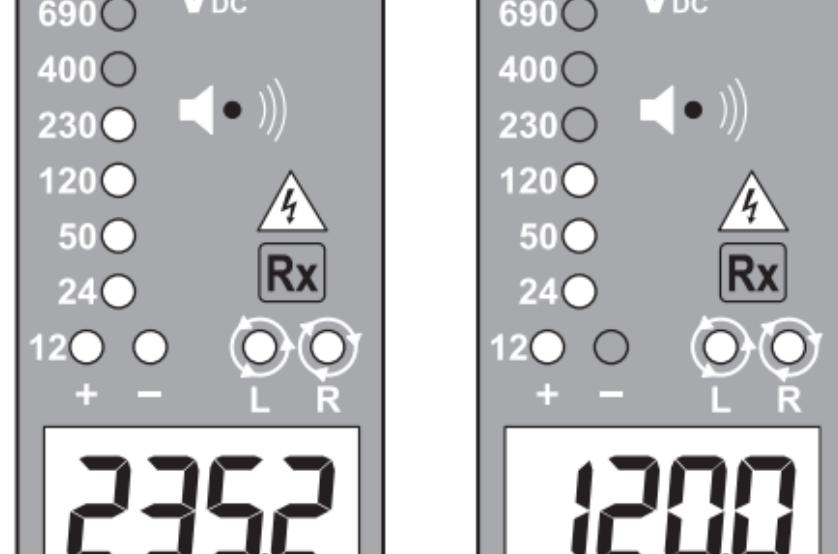
Conecte ambas sondas de prueba al circuito probado. La tensión es indicada por los LED y la pantalla LCD.
