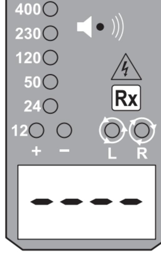
Asegúrese de que el circuito probado no tenga alimentación. Conecte ambas sondas de prueba al circuito. El LED de continuidad (Continuity LED) se enciende y el timbre suena continuamente para indicar la continuidad  $< 500 \text{ k}\Omega$ . Nota: No hay medición de continuidad disponible en la pantalla LCD.
