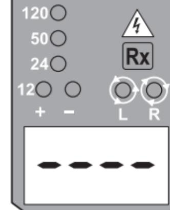
Tenez le testeur fermement. Connectez la sonde « L2 + » à l'objet à tester.
