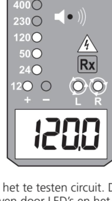
Koppel beide sondes aan het te testen circuit. De spanning wordt aangegeven door LED's en het LCD-display.
