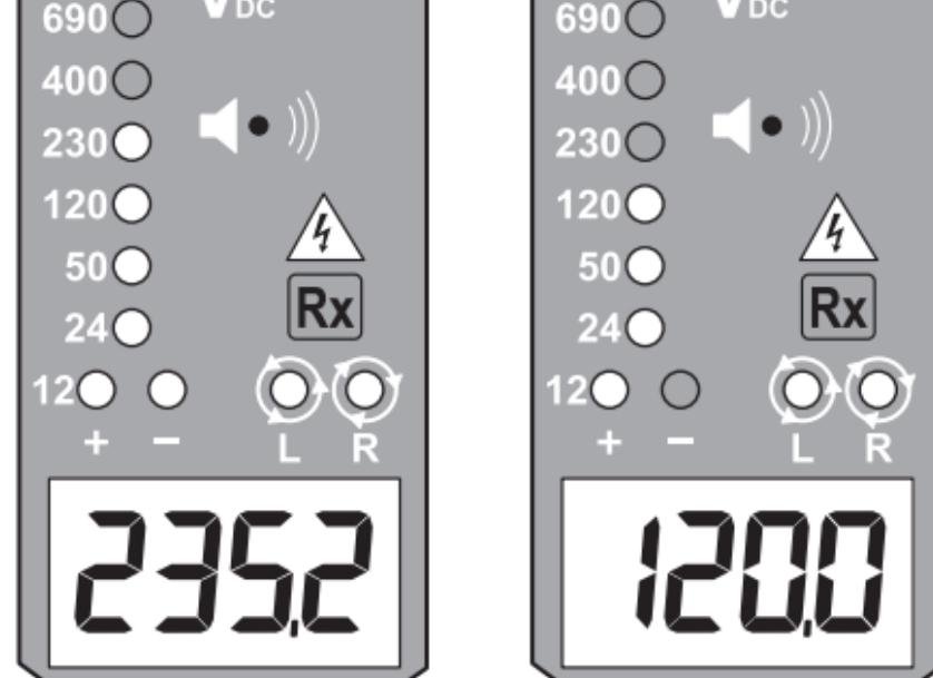
Collegare entrambe le sonde al circuito da testare. La tensione è indicata dai LED e dal display LCD.
