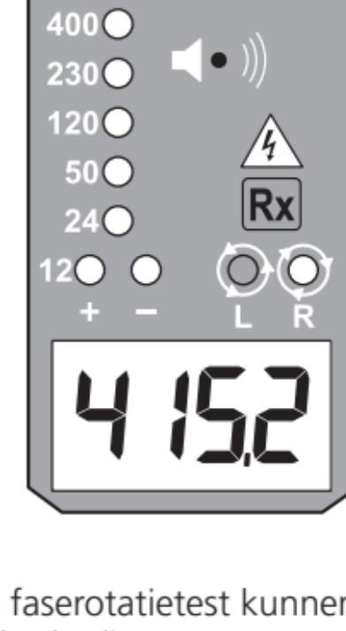
L-LED en R-LED's voor de faserotatietest kunnen werken op verschillende bedradingssystemen, maar een effectief testresultaat kan alleen worden verkregen op drie-fasen 4-kabelsystemen.
