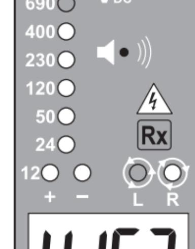
I LED L e R per il test di rotazione fase possono operare su diversi sistemi di cablaggio, ma un risultato efficace di test può essere ottenuto solo su sistemi trifase a 4 cavi.
