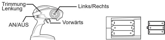
Einlegen von Batterien: Öffnen Sie die Batterieabdeckung der Fernbedienung und legen Sie 3x 1,5 V AA Batterien ein. Achten Sie dabei auf die richtige Polarität. (Batterien sind nicht im Lieferumfang enthalten)
