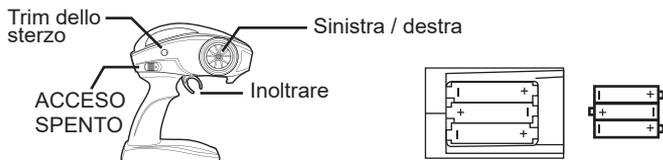
Inserimento delle batterie: aprire il coperchio del vano batterie del telecomando e inserire 3 batterie AA da 1,5 V. Prestare attenzione alla corretta polarità. (Le batterie non sono incluse)
