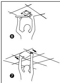
→ In principe bevindt zich aan het plafond waar een toegangspunt is gemonteerd, alleen de netwerkabel. De PoE-voeding wordt meestal aangesloten in de buurt van de router, netwerkswitch of modem.
