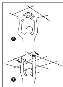
Pour ce faire, insérez les 4 boulons de fixation de l'appareil dans les 4 trous du support de plafond et poussez l'appareil loin des lignes de raccordement jusqu'à ce qu'il s'enclenche.
