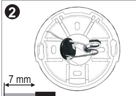
Drähte durch Dichtung führen Insert wires into gasket
