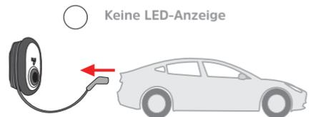
2. Stecken Sie den Ladestecker in die Blindbuchse der Ladestation.
