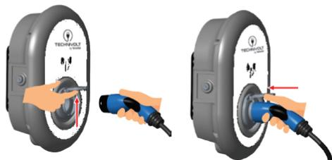
3. Um die Kabelverriegelungsfunktion zu aktivieren, stellen Sie den DIP-Schalter Nr. 3 mit einem spitzen Kunststoffwerkzeug auf ON. Die Position der DIP-Schalter ist in der folgenden Abbildung dargestellt.
