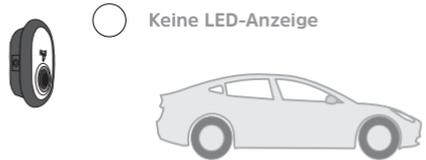
2. Verbinden Sie Ladestation und Fahrzeug mit dem Ladekabel. Stecken Sie dafür den Ladestecker in die Steckdose des Fahrzeugs und der Ladestation.
