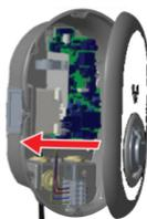
5. Öffnen Sie die vordere Abdeckung der Steckdose und stecken Sie das Ladekabel in die Steckdose.
