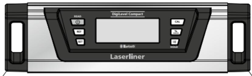
3. Acum nivela se rotește orizontal la 180° și se așează exact pe suprafața marcată (măsurare prin culcare). După aceea se apasă din nou tasta READ (1). -2- pâlpâie. Semnalul sonor final finalizează operațiunea.
