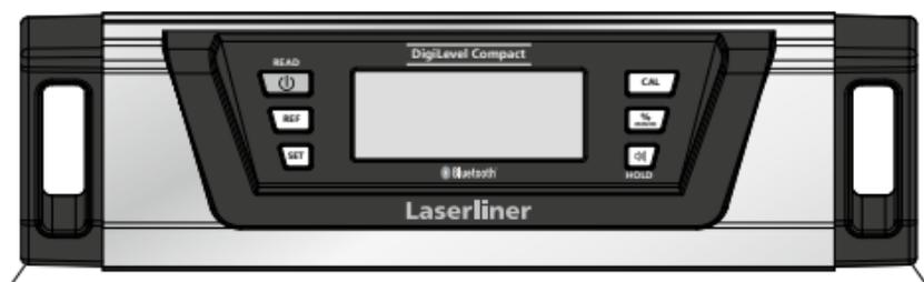
3. Сега либелата да се завърти хоризонтално на 180° и да се постави точно на маркираната повърхнина (измерване чрез обръщане).
