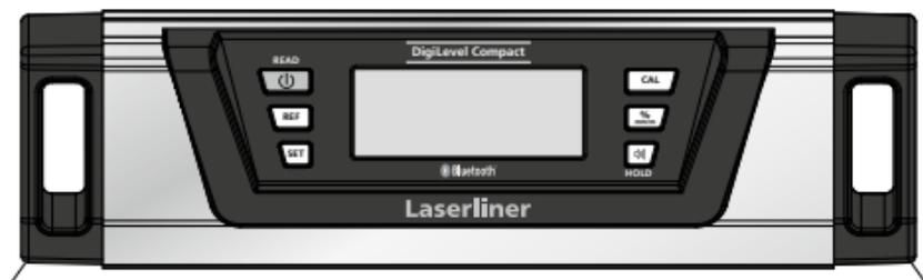
3. Nyní vodováhu horizontálně otočte o 180° a položte přesně na označenou plochu (měření s otočením). Potom opět stiskněte tlačítko READ (1). -2- bliká.
