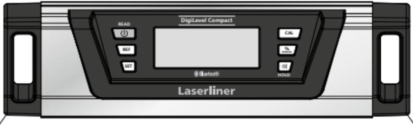
3. Тепер поверніть рівень на 180° по горизонталі і встановіть прямо на позначену площу (вимір оберту). Після цього ще раз натиснути кнопку READ (1). -2- блимає. Звуковий сигнал припиняє процес.
