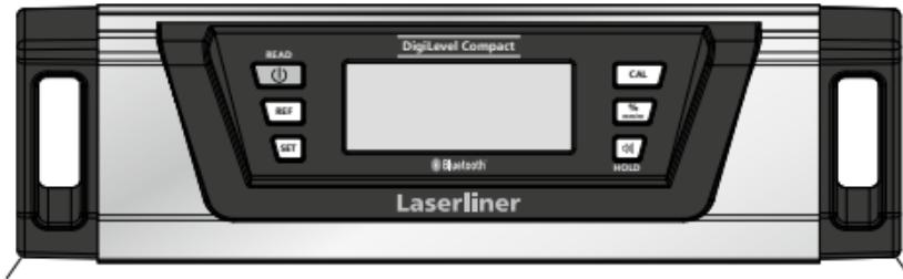
3. Draai de waterpas nu horizontaal 180° en plaats deze exact op het gekenmerkte oppervlak (omslagmeting).
