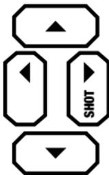
Mit der Pfeil-nach-rechts-Taste kann ein Bild ausgelöst werden. Dieses wird danach auf der SD-Karte gespeichert (und nicht versendet).
