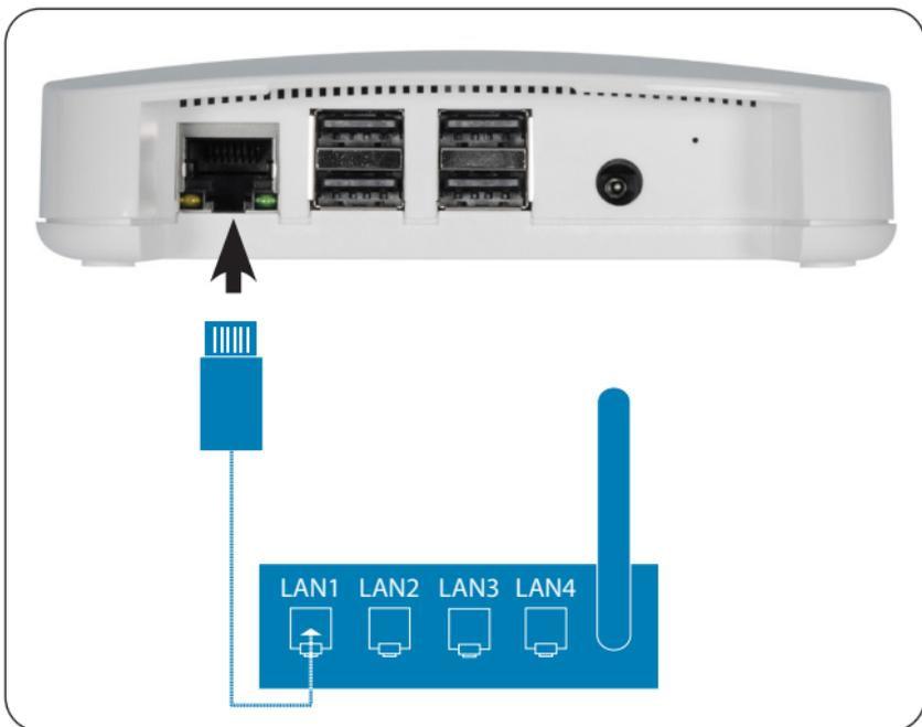
Nach Anschluss des Steckernetzteils (s. Kap. 8.2) wird bei korrektem Anschluss die grüne LED am LAN-Anschluss leuchten. Die gelbe LED blinkt, wenn Daten übertragen werden.
