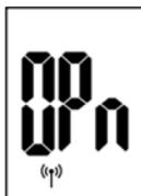
Si el contacto externo de puerta/ventana DuoFern detecta una ventana abierta, se muestra este mensaje (**OPn**) durante todo el tiempo que dure el proceso.
