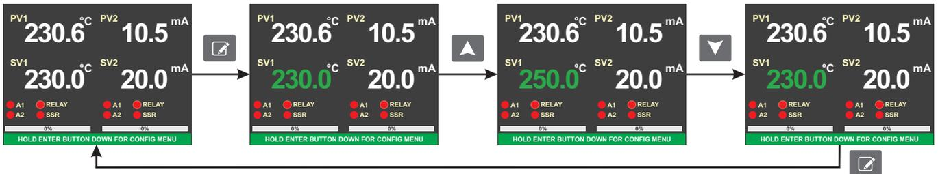
Wenn die Set-Taste einmal gedrückt wird, leuchtet die SV1 LED grün. Durch Drücken der Tasten Auf / Ab wird der SV1 Wert eingestellt. Mit erneutem Betätigen der Set-Taste oder 3 Sekunden warten, wird der Wert gespeichert und die Farbe der SV1 LED wird wieder weiß.
