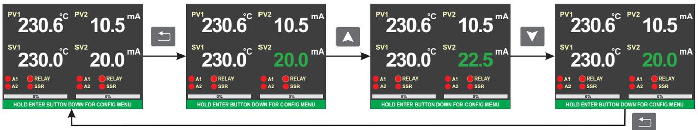
Wenn die Zurück-Taste gedrückt wird, leuchtet die SV2 LED grün. Durch Drücken der Tasten Auf / Ab wird der SV1 Wert eingestellt. Mit erneutem Betätigen der Set-Taste oder 3 Sekunden warten, wird der Wert gespeichert und die Farbe der SV1 LED wird wieder weiß.
