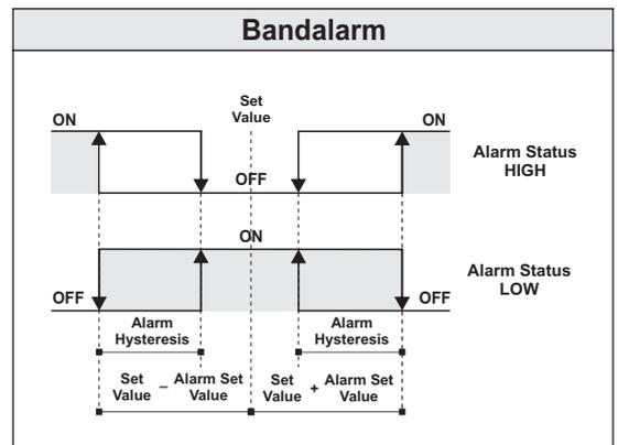
Bandalarm mit Unterdrückung (nach dem Einschalten)
