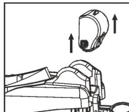
Laad de led-lamp (9) met behulp van de meegeleverde USB-oplaadkabel (4) een geschikte netvoeding op. Zorg ervoor dat uw netvoeding overeenkomt met de vereiste technische gegevens.
