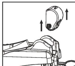
Chargez la lampe LED (9) à l'aide du câble de charge USB fourni (4) branché à un bloc d'alimentation approprié. Veillez à ce que votre bloc d'alimentation soit conforme aux spécifications techniques requises.
