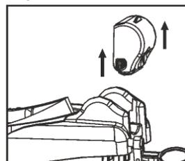
Caricare la luce a LED (9) utilizzando il cavo di ricarica USB in dotazione (4) con un alimentatore adatto. Assicurarsi che l'alimentatore sia conforme ai dati tecnici richiesti.
