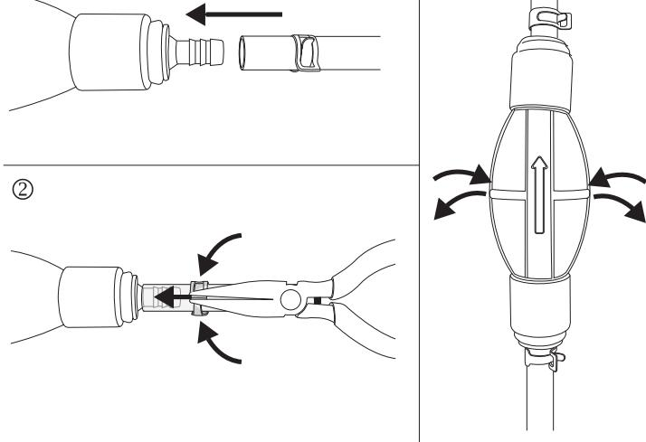
• Insérez les tuyaux avec leurs extrémités, où se trouvent les brides, sur les raccordements de la pompe (voir l'illustration 1).
