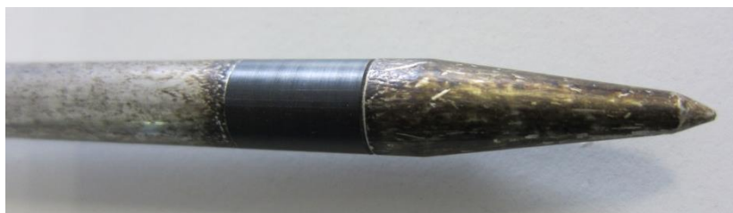
Verunreinigte Elektrodenspitze -> misst falsch!
