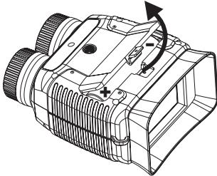
Öffnen Sie die seitliche Gummischutzhülle und verbinden das beiliegende USB-C™-Kabel mit der USB-C™-Buchse. Verbinden Sie den USB-A-Stecker mit einem Computer oder einem USB-Ladegerät.
