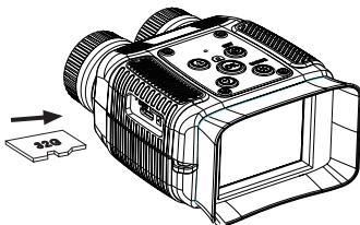
Öffnen Sie die seitliche Gummischutzhülle und schieben die Speicherkarte Seitenrichtig in den Kartenschlitz ein, bis die Karte verriegelt wird. Zum Entnehmen drücken Sie die Karte geringfügig hinein, bis diese entriegelt wird.
