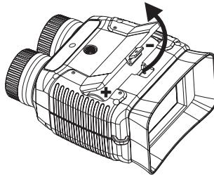
Ouvrez le couvercle de protection latéral en caoutchouc et raccordez le câble USB-C fourni à la prise USB-C™. Connectez un ordinateur ou un chargeur USB à la prise USB-A.
