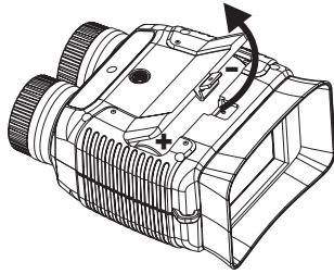
Open het rubberen beschermkapje aan de zijkant en sluit de meegeleverde USB-C™-kabel aan op de USB-C™-aansluiting. Sluit de USB-A-stekker aan op een computer of een USB-oplader.
