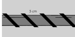
Das Thermostat am Ende des Heizkabels sollte immer an der kältesten Stelle des Rohres mit Isolierband guter Qualität angebracht werden. Nur so kann ein optimaler Betrieb gewährleistet werden. Achten Sie darauf, dass das Thermostat eng am Rohr anliegt.
