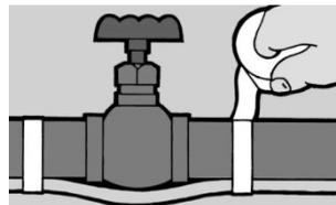
Für Wasserrohre mit einem größeren Durchmesser benutzen Sie zwei parallel gegenüber verlaufende Heizkabel. Die maximale Überlagerung sollte 1 m nicht übersteigen.
