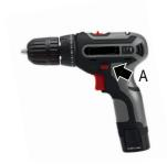
In der Mittelstellung blockiert der Drehrichtungsumschalter den Ein-/Ausschalter und damit den Motor im Akku-Bohrschrauber.
