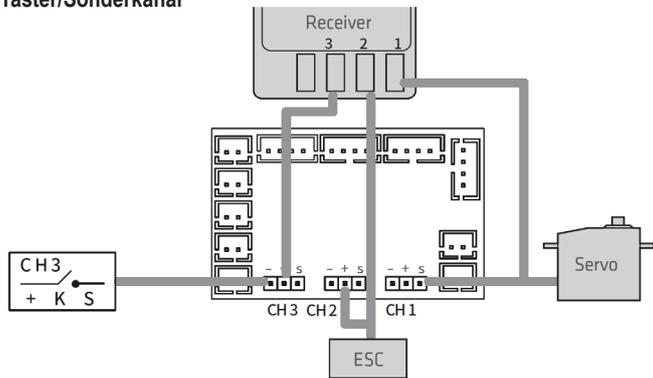
**CH1:** Beide Enden des Kabelbaums werden mit dem Servo bzw. CH1 der Hauptsteuerplatine verbunden.
