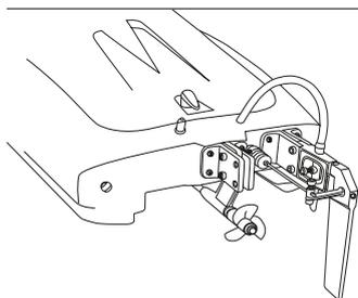
**Benutzen Sie spezielles Boots Abkleband um das Deck auf dem Rumpf zu montieren. Das Band ist mehrfach verwendbar. Andere Klebebänder funktionieren nur bedingt, ein Wassereintritt findet evtl. statt sobald das Boot auf dem Rücken liegt, somit sollten andere Klebebänder nur mit Vorsicht oder am besten gar nicht verwendet werden.**
