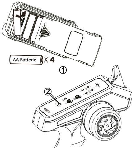
1. Sie benötigen 4x1.5V Mignon AA Batterien. Legen Sie diese korrekt gepolt (+/-) ein. Sofern Sie die Fernsteuerung ein paar Tage nicht benutzen, entnehmen Sie bitte die Batterien, da diese sonst auslaufen können und die Kontakte beschädigt werden.
