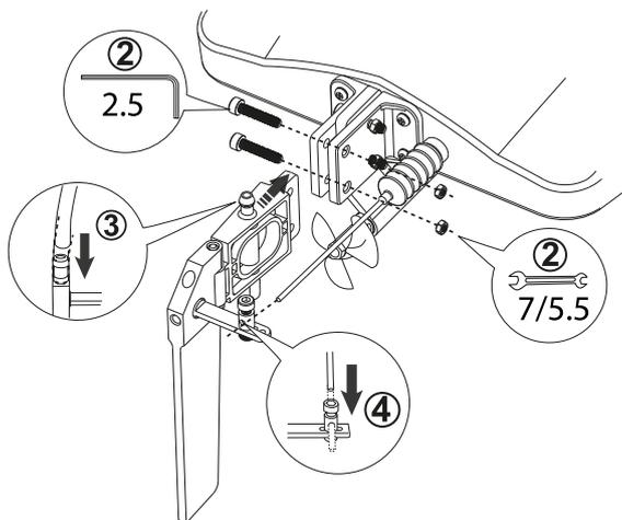
Schrauben Sie mittels 2.5mm Imbus die Schrauben ein, und ziehen diese mittels 7/5.5 Schlüssel fest. Stecken Sie den Kühlwasserschlauch auf den Anschluss im Ruder. Prüfen Sie ob der Kühlkreislauf ordnungsgemäß funktioniert (z.B. Einlass oder Auslass unter Wasserkran halten und schauen ob das Wasser an der anderen Seite austritt. Achten Sie bei der Montage des Ruders (NR.4) darauf dass das Lenkservo und dessen Trimmung im eingeschaltetem Zustand neutral stehen bevor Sie das Gestänge festschrauben.
