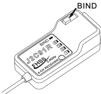
Sollten Sie Empfänger oder Fernsteuerung tauschen oder einen weiteren Empfänger mit dieser Fernsteuerung betreiben, so müssen Sie die Komponenten miteinander binden.
