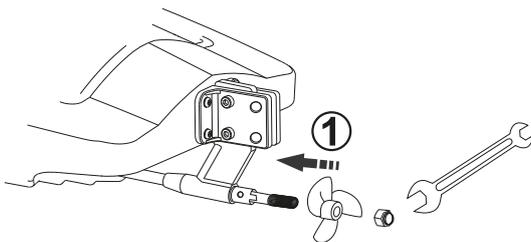
Benutzen Sie einen 7mm Schlüssel um die Mutter zu lösen. Stecken Sie den Propeller auf und schrauben Sie die Mutter fest.
