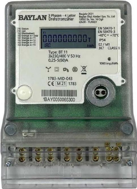
*Stromzähler der Reihe Baylan BT.1x ist ein moderner, voll programmierbarer Stromzähler zum Erfassen des Verbrauches der elektrischen Energie im Bereich des Kleinverbrauches. Das Gerät ist in der Lage die Anforderungen an Erfassen der Wirkenergie in der Genauigkeitsklasse A oder B zu erfüllen. Seine Konstruktion wurde für Anschluss ans Netz vom Typ TN-C entworfen.*
