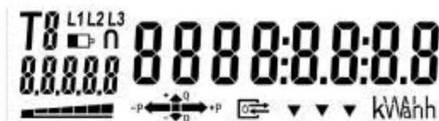
Für bessere Orientierung ist im LCD durch ein Balkendiagramm ungefähre Größe der momentanen Leistung angezeigt. Liegt der Strom in allen Phasen gleichzeitig unter dem Anlaufwert, wird das Balkendiagramm nicht angezeigt. Überwiegt die Lieferung über dem Bezug, blinkt das Balkendiagramm und LED leuchtet dauerhaft an.
