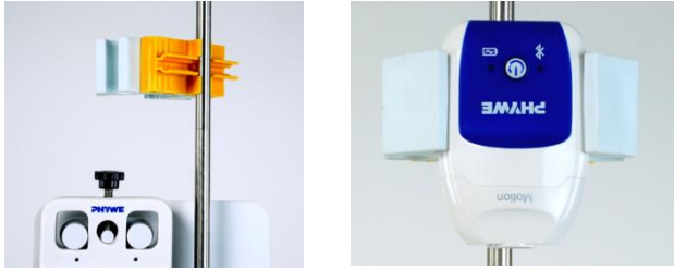
Abb. 6+7 Befestigung des Motion Sensors
