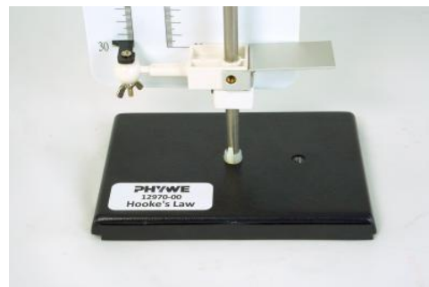
Abb. 4 Montierte Stange auf der Grundplatte
