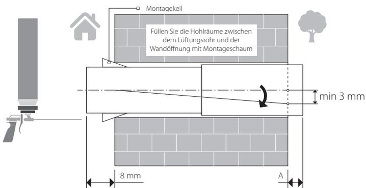
Setzen Sie das Lüftungsrohr in die Wand ein, wie links abgebildet.
