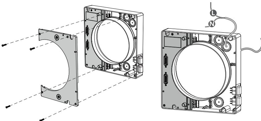
4. Markieren Sie mit der mitgelieferten Papp-Montageschablone die Löcher zur Befestigung der Lüftungsanlage wie in der folgenden Abbildung gezeigt. Bohren Sie die Öffnungen und setzen Sie die Dübel ein. Installieren Sie die Montageplatteneinheit an der
