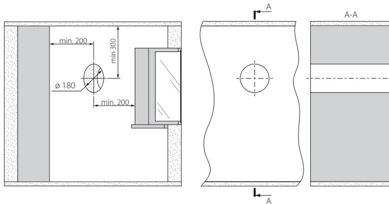
2. Das Lüftungsrohr in die Wand einsetzen und mit Hilfe der mitgelieferten Styropor-Keile und Montageschaum fixieren. An der Außenwand muss das Lüftungsrohr um den Abstand herausragen, der für die Montage der Außen-Lüftungshaube erforderlich ist.
