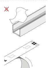
Kleben Sie den LED-Streifen niemals über eine Profilstoßstelle hinweg! Durch das physikalisch bedingte Ausdehnen bzw. Zusammenziehen des Profils bei Temperaturschwankungen kann der LED-Streifen beschädigt werden. Abhilfe schafft hier das richtige Teilen bei den Lötpads an der Stoßstelle und der Einsatz von flexiblen Verbindungen, z.B. angelötete flexible Drahtbrücken oder LED-Streifen Verbinder.
