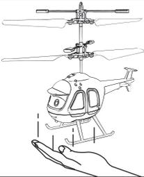
**Flug starten:** Wähle einen großen Bereich. Schalte den Hubschrauber mit dem Schalter ein. Nach 3 Sekunden hebt er automatisch ab. Er wird über deiner ausgestreckten Hand schweben. Die Flugdauer beträgt etwa 5 Minuten.
