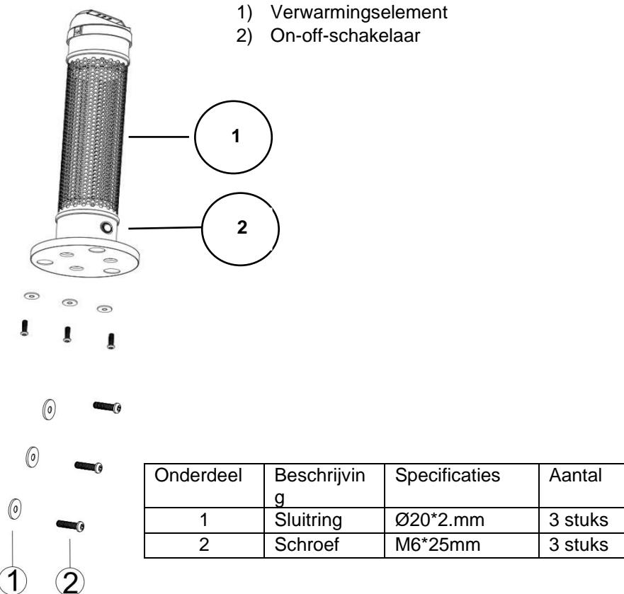
Het is belangrijk dat de schroeven twee weken na de montage en vervolgens om de drie maanden op stevige bevestiging worden gecontroleerd en zo nodig worden aangedraaid.
