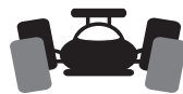
Déport positif (les bords supérieurs de la roue sont tournés vers l'extérieur)
