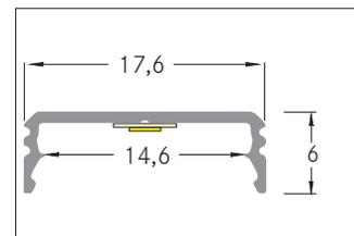
Anbauprofil, flach, alu eloxiert. Zur optimalen Befestigung des Profils eignen sich die Halter 53040000. In Verbindung mit den Profilabdeckungen 53489071 53489072 53489073 53489001 53489002 53489003 kann sowohl ein zusätzlicher mechanischer Schutz als auch eine optimale Lichtverteilung erreicht werden. Das zugehörige Endkappen-Set steht unter 53038260 zur Verfügung. Montageart: Anbauprofil, Material: Aluminium, Abmessung Profil: L: 2.000 mm x B: 17,6 mm x H: 6 mm.
