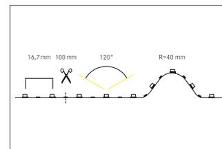
QualityFlex Performance CRI > 95, 15 W / m, IP00, LED-Weißlicht, 6000K, CRI > 95 LED-Flexplatine Länge: 10000.0 mm Lampenleistung je Meter: 15.0 W/m, Schutzart: IP00, Schutzklasse: III, Spannung: 24V DC, Abstrahlwinkel: 120.0 °, 60 LEDs pro Meter, Chip-Abstand (Short Pitch) : 16,66mm. Zur Individuellen Anwendung kann die LED-Flexplatine alle 100 mm eingekürzt werden. Die Maximale Systemlänge von 10.000mm darf mit einer Einspeisung nicht überschritten werden.
