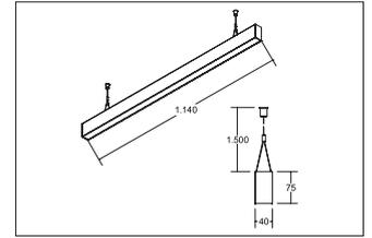
LED-Pendel-Profilleuchte direkt BIRO40, silber, rechteckigAusführung: LED, Montageart: Pendelmontage, Montageort: Deckenmontage, Material: Aluminium / Acryl, Schutzart: nach DIN EN 60529: IP20, Schutzklasse: (EN 61140) I, Spannung: 230V AC 50Hz, Leistung: 17.9W, Lichtstrom: 1.620lm, Farbtemperatur: 4000 K, Lichtfarbe: weiß, Abstrahlwinkel: 80°, Verstellbarkeit: nicht verstellbar, mit Betriebsgerät, Art der Dimmung: schaltbar .
