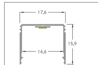
Anbauprofil, hoch. Zur optimalen Befestigung des Profiles eignen sich die Halter 53040000. In Verbindung mit den Profilabdeckungen 53489071 53489072 53489073 53489001 53489002 53489003 kann sowohl ein zusätzlicher mechanischer Schutz als auch eine optimale Lichtverteilung erreicht werden. Das zugehörige Endkappen-Set steht unter 53039260 zur Verfügung. Montageart: Anbauprofil, Material: Aluminium, Abmessung Profil: L: 1.000 mm x B: 17,6 mm x H: 15,9 mm.
