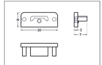
Endkappen-Set, weiß. In Verbindung mit den Profilabdeckungen 53400000 53400070 kann sowohl ein zusätzlicher mechanischer Schutz als auch eine optimale Lichtverteilung erreicht werden. Abmessung Profil: L: mm x B: 20 mm x H: 8 mm.
