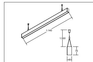
LED-Pendel-Profilleuchte direkt/indirekt BIRO40, silber, rechteckigAusführung: LED, Montageart: Pendelmontage, Montageort: Deckenmontage, Material: Aluminium / Acryl, Schutzart: nach DIN EN 60529: IP20, Schutzklasse: (EN 61140) I, Spannung: 230V AC 50Hz, Leistung: 45.9W, Lichtstrom: 5.060lm, Farbtemperatur: 3000 K, Lichtfarbe: weiß, Abstrahlwinkel: 80°, Verstellbarkeit: nicht verstellbar, mit Betriebsgerät, Art der Dimmung: schaltbar .
