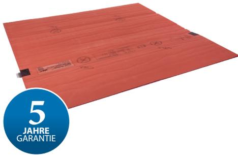
DEVIdry™ ist ein Fußbodentemperiersystem in Trockenbauweise zur Verlegung unter Laminat und Teppichbelägen. Es besteht aus einer Schaummatte mit einer Höhe von nur 8 mm mit integrierten Hezelementen.
