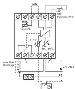
**WICHTIG:** Wird ein Thermostat zur Steuerung eines Fußboden-Heizelements in Verbindung mit einem Fußbodenbelag aus Holz oder einem ähnlichen Material verwendet, ist ein Bodenfühler erforderlich. Die maximale Bodentemperatur darf niemals 35 °C überschreiten.
