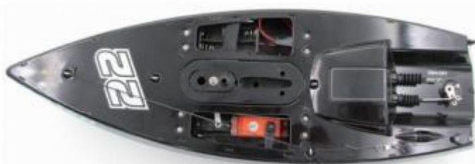
Kadłub zainstalowany z serwomechanizmami i pojemnikiem na baterie
