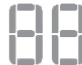
**Affichage de l'Humidité et de la Minuterie** - Lorsque l'appareil est mis en marche, il affiche le taux d'humidité effectif de la pièce. Lorsque le taux d'humidité est adapté, l'humidité sélectionnée clignote brièvement à l'écran, puis le taux d'humidité effectif s'affiche. Lorsque le taux d'humidité de la pièce est inférieur à 35 %, il affiche "35". Lorsque le taux d'humidité de la pièce est supérieur à 95 %, il affiche "95".
