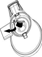
4. Das Schneckengehäuse mit dem Treterauswurf nach links und dem Saftauslauf nach vorne auf die Motoreinheit aufsetzen.
