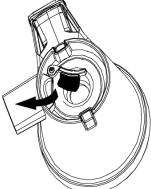
4. Inserite l'alloggiamento dell'elica trainante tenendo l'apertura di fuoriuscita della polpa rivolta verso sinistra e quella di fuoriuscita del succo rivolta sul davanti dell'unità motore.
