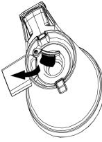
4. Acople la carcasa de transmisión helicoidal de modo que la salida de pulpa esté a la izquierda y la salida de zumo hacia delante y dirigido hacia la unidad de transmisión.
