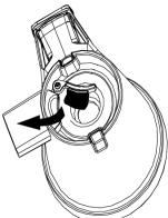
8. Σηκώστε το μάνδαλο κλειδώματος στο πίσω μέρος της μονάδας κίνησης.
